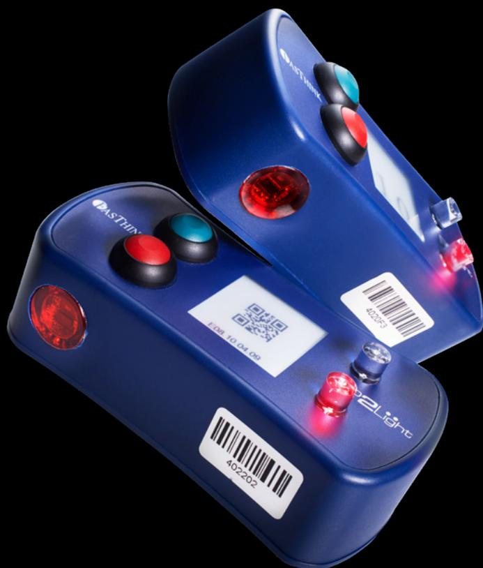
P2Light è composto da una antenna Gateway in grado di gestire in modalità wireless pulsanti luminosi disponibili in diverse versioni per soddisfare al meglio le necessità di utilizzo come per esempio
