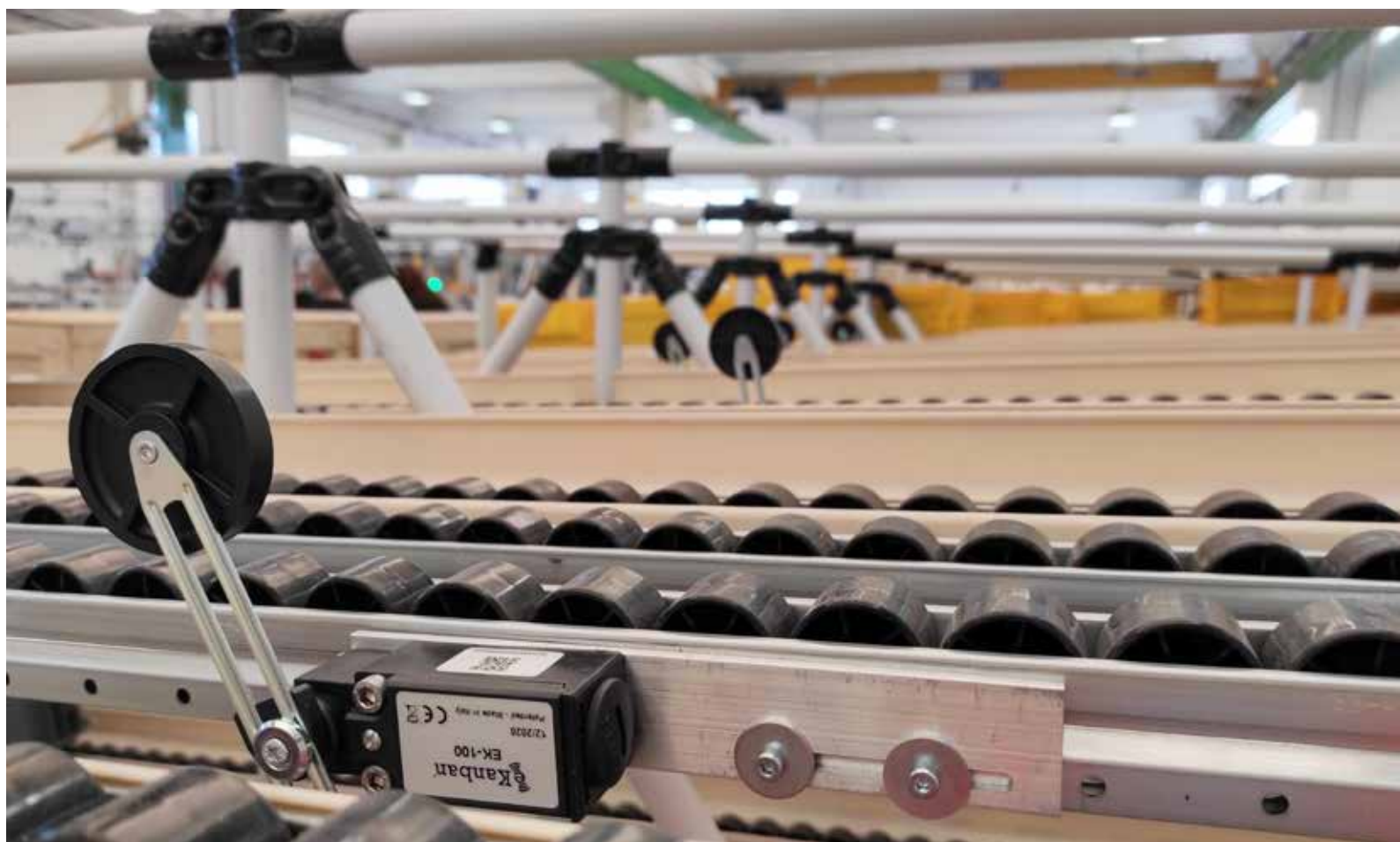
IL SISTEMA E-KANBAN INSERITO SULLE RULLIERE
